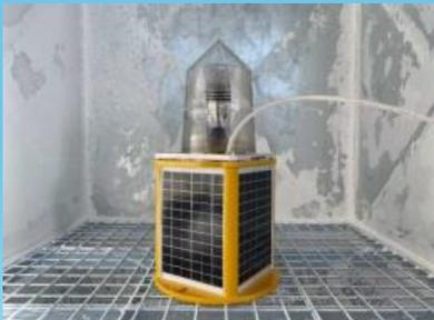
Test di protezione IP68.
